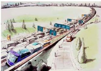
La rentrée et la sortie des sites propres se fait dans des stations. Ces stations qui font aussi office de parking peuvent s'échanger des véhicules vides sans intervention humaine sur commande du système de gestion. Cette version apporte une automatisation et un service instantané sur les sites propres en permanence. Elle résout aussi le problème du déplacement automatique des véhicules vides entre les parkings qui sont sur le site propre (il peut y avoir d'autres parkings).
