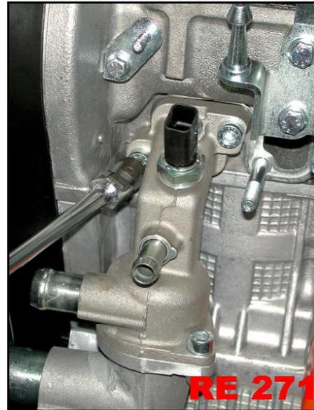
Le clapet du calorstat alors peut être déposé du corps de calorstat en retirant les 2 vis.
