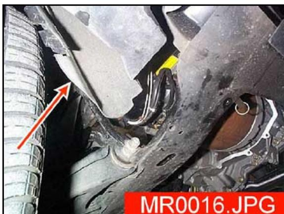
16. Desserrer légèrement la 3ème vis du support de pompe à vide. Le support a une forme de fourchette et reste donc en appui contre cette vis.
