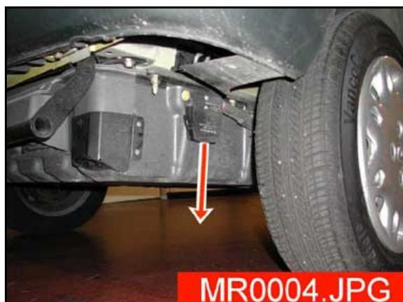
3. Débrancher la batterie 12 V.
