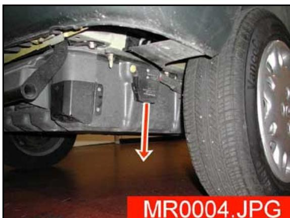
2. Débrancher la batterie 12 V.
