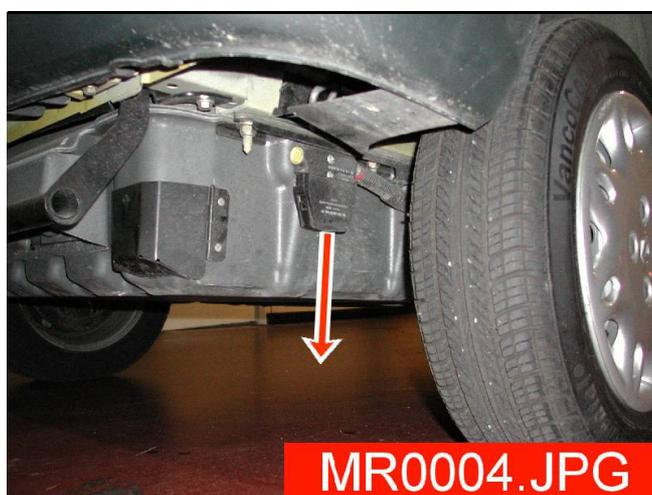
2. Débrancher la batterie 12 V.
