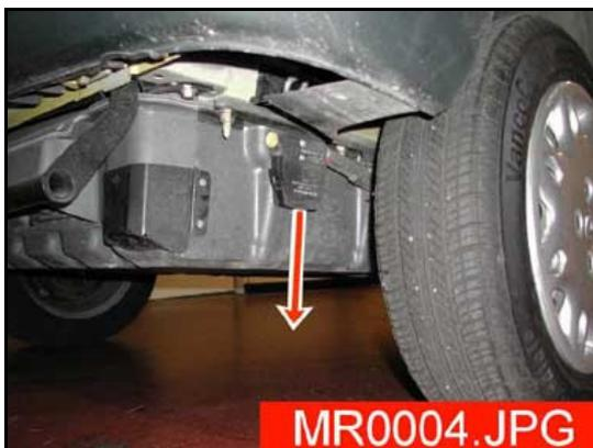
2. Débrancher la batterie 12 V.
