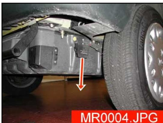
3. Débrancher la batterie 12 V.
