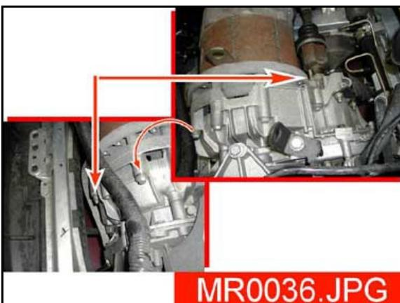
23. Placer une chèvre sur le moteur avec 2 points d'ancrage : CEVE + moteur (+ positionneur de charge).
