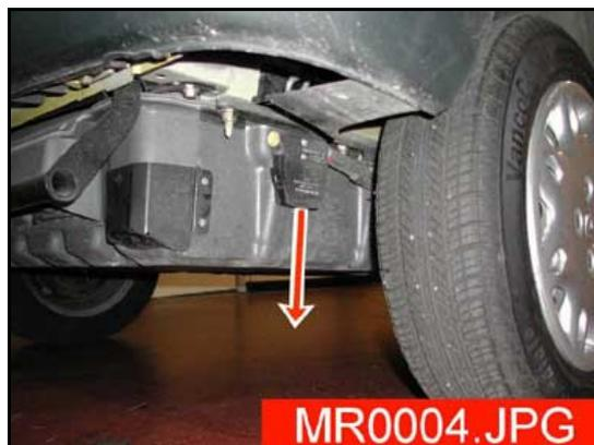
3. Débrancher la batterie 12 V.
