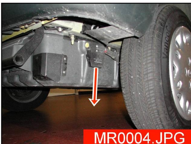
3. Débrancher la batterie 12 V.
