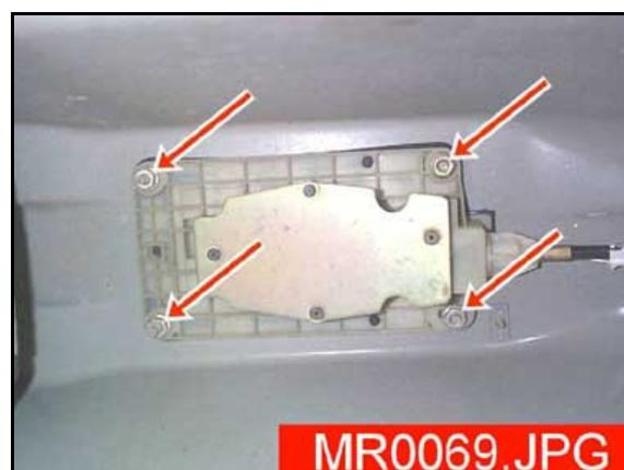
15. Pour extraire le câble, dévisser les 4 vis de la plaque inférieure du sélecteur et en soulever le caoutchouc de protection.
