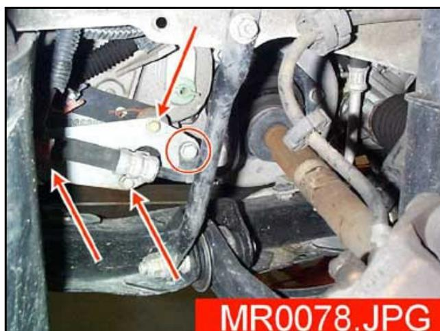
9. Déconnecter le connecteur de l'actionneur du doigt de blocage.
