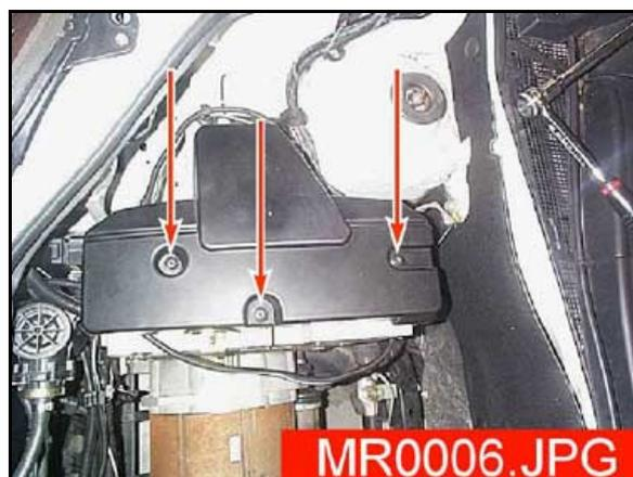
4. Enlever les écrous des câbles HT (dévisser en premier la borne positive avec une clé de 16, puis la borne négative avec une clé de 13).
