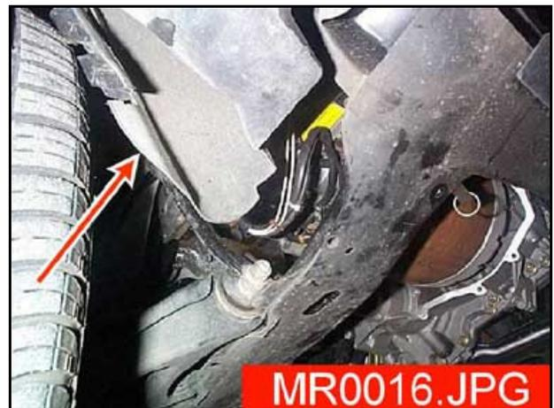
17. Desserrer légèrement la 3ème vis du support de pompe à vide. Le support a une forme de fourchette et reste donc en appui contre cette vis.
