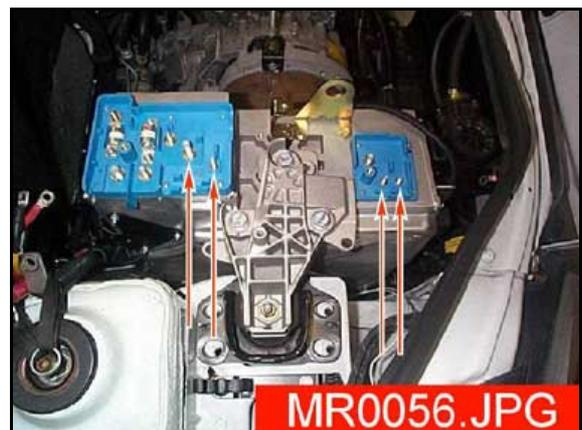
5. Dégrafer le câblage du côté de l'aile droite.
