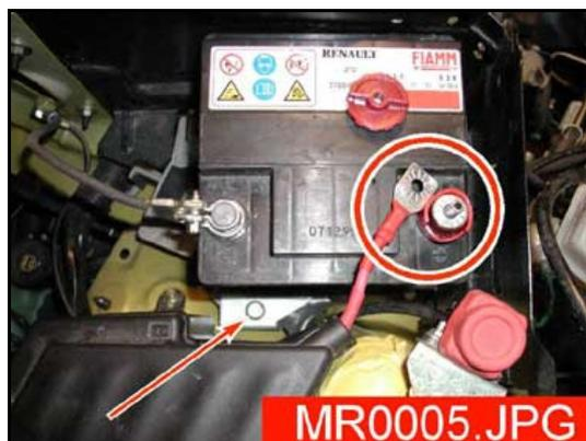
4. Déposer la batterie 12 V en dévissant l'écrou.
