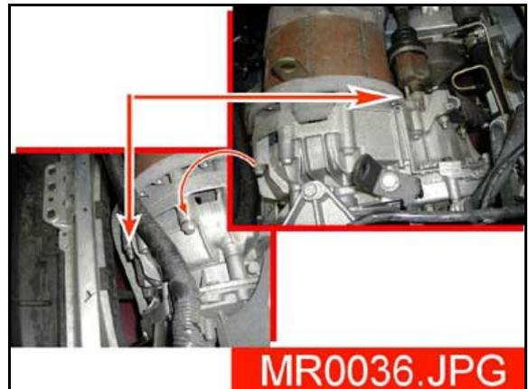
5. Dévisser complètement les 2 vis supérieures de liaison entre le moteur et la boîte aux extrémités et desserrer légèrement la 3ème vis centrale.
