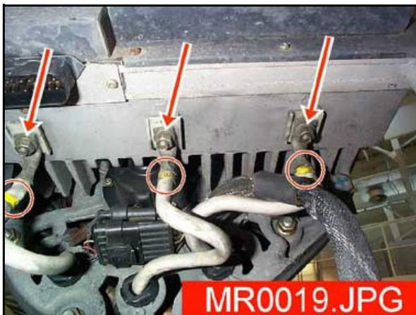
20. Dévisser les 2 vis de liaison entre le CEVE et le moteur avec une clé à cardans (bien repérer les 2 vis car elles n'ont pas la même longueur, la plus grande est sur l'avant du véhicule).
