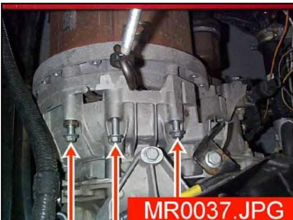
22. Retirer le 1er goujon de liaison moteur-boîte en bas du moteur, puis le 2ème goujon (utiliser un écrou + contre-écrou).
