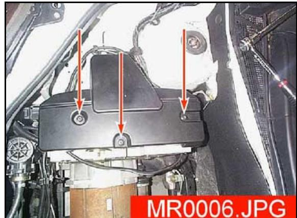
4. Déposer les câbles HT et secteur du bornier CEVE.
