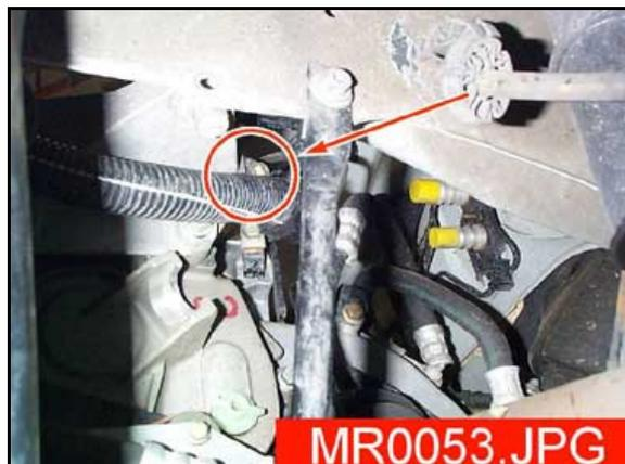
13. Dévisser les 2 vis et le boulon de fixation du soufflet de cardan.
