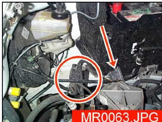
4. Dévisser les 2 vis de fixation du potentiomètre sous le support batterie.
