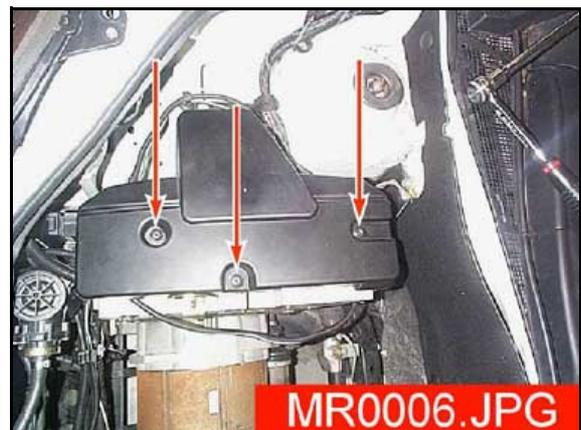
7. Débrancher toute la connectique (tresse de masse comprise) du filtre 100Hz en maintenant les cosses lors de l'opération pour éviter leur rotation.
