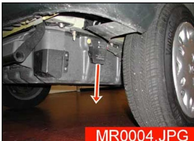
3. Débrancher la batterie 12 V.
