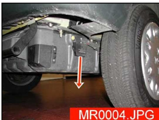
3. Débrancher la batterie 12 V.
