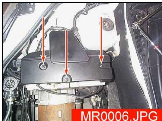
4. Débrancher le + 12 V en sortie de CEVE qui va vers la batterie.
