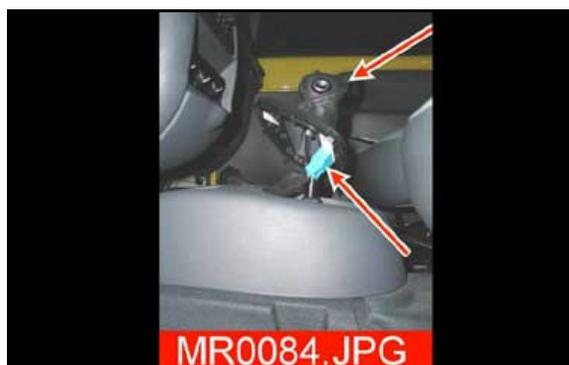
5. Déposer la console en dévissant les 2 vis supérieures.
