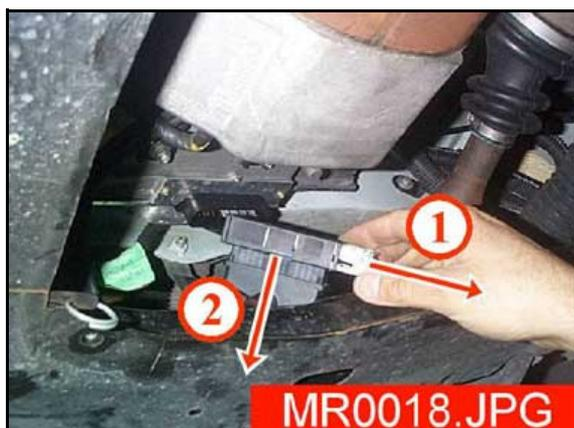
21. Retirer le fil de masse sur la caisse (fixé avec la masse batterie).
