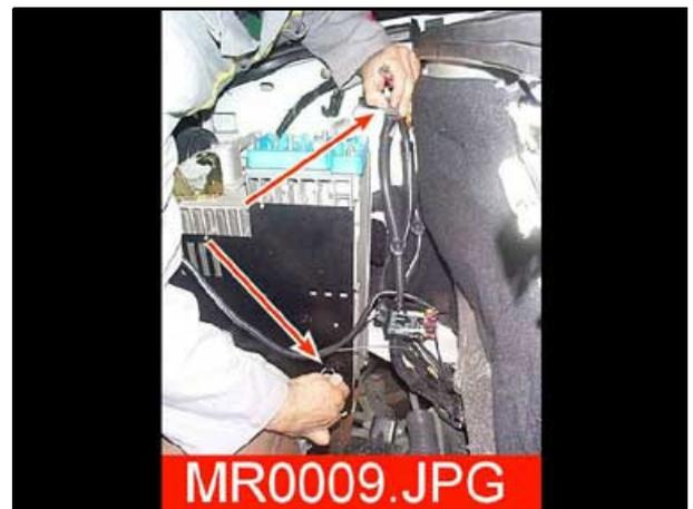
8. Déverrouiller le connecteur 90 voies et le débrancher (tirer le verrou en haut).
