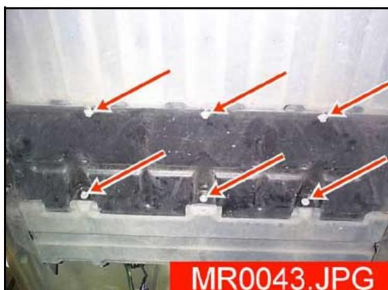
11. Déposer la patte de maintien entre le berceau et la caisse (sur le côté droit).
