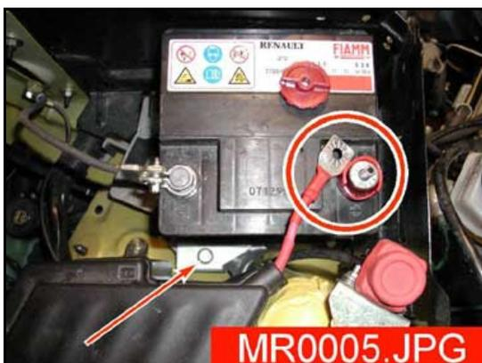
3. Démontez le capot de protection du CEVE (vis Torx de 30).
