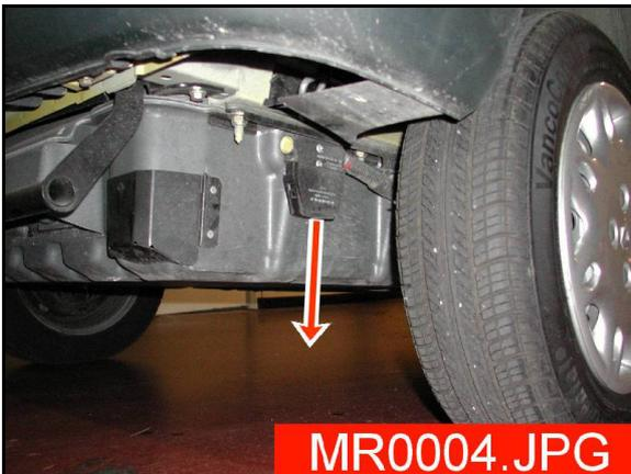
2. Débrancher la batterie 12 V.
