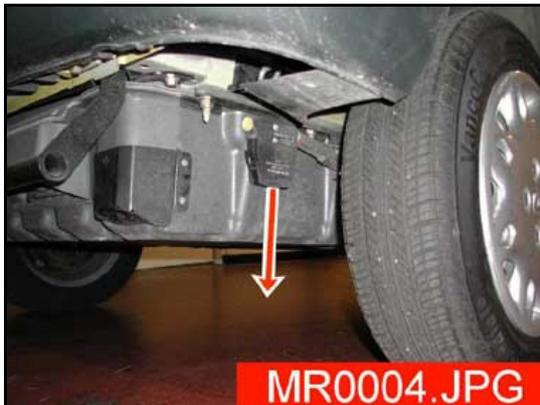
2. Débrancher la batterie 12 V.
