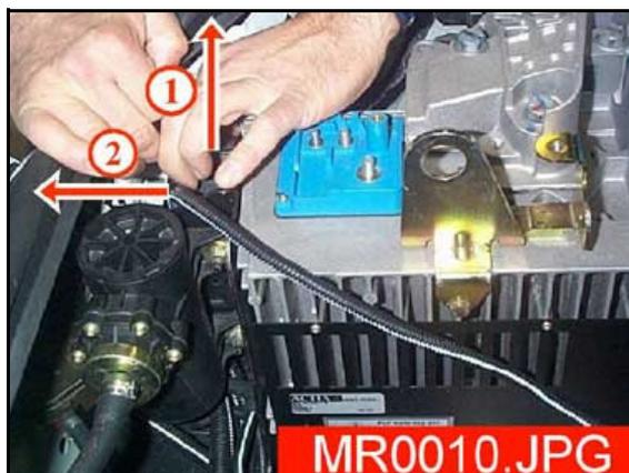
7. Débrancher le connecteur R98 et le déclipser. Déclipser le câblage du support du GMV.
