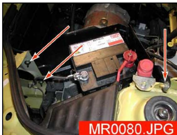
8. Dégrafer le connecteur de sens de marche (avant-arrière).
